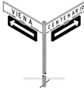
Colocación de las señales de nomenclatura complementadas con flechas de sentido de circulación
